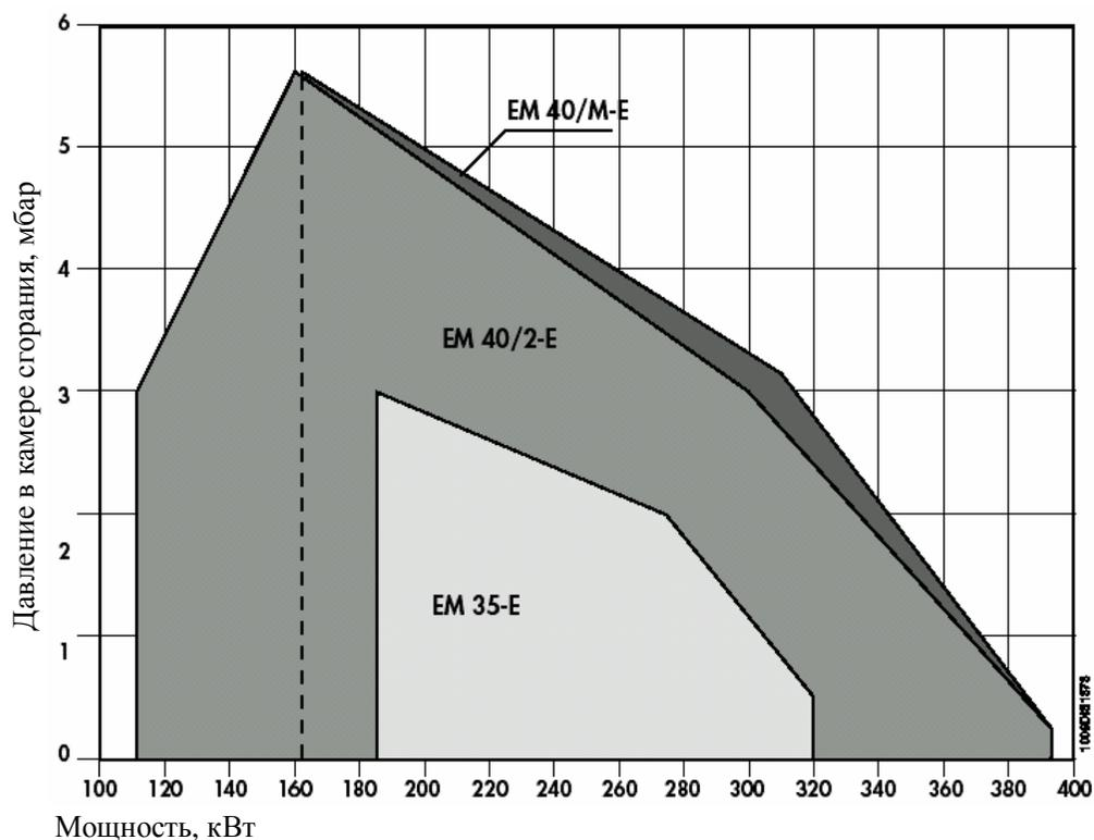
Кривые, представленные на диаграмме, показывают выходную мощность (в кВт) в зависимости от противодавления (в мбар) в камере сгорания.
