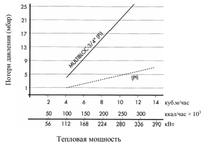
**Pi** Давление на входе (насадка сгорания + линия подачи газа)
