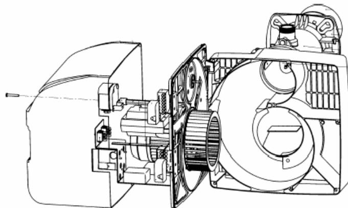
Чтобы обеспечить доступ к расположенным внутри узлам и деталям, снимите крышку.
