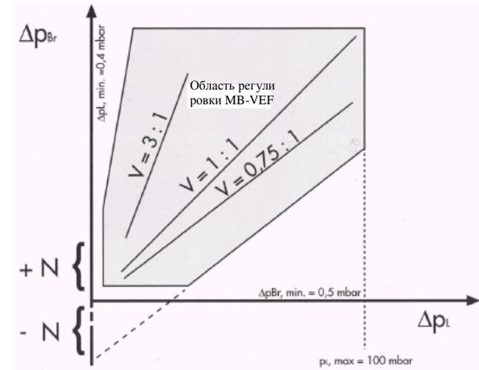
**РЕГУЛИРОВКА КЛАПАНА МУЛЬТИБЛОКА**
