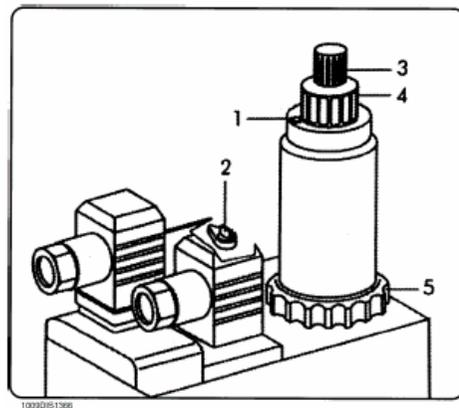
Чтобы отрегулировать расход на 1<sup>ой</sup>/2<sup>ой</sup> ступенях, ослабьте винт 1. При вращении 4 и 5 против часовой стрелки расход будет возрастать. При вращении по часовой стрелке — уменьшаться. После того, как будет проведена необходимая регулировка, снова затяните винт 1. Чтобы отрегулировать механизм начального срабатывания, снимите крышку 3 и вращайте ось, используя в качестве подсобного инструмента заднюю сторону крышки.
