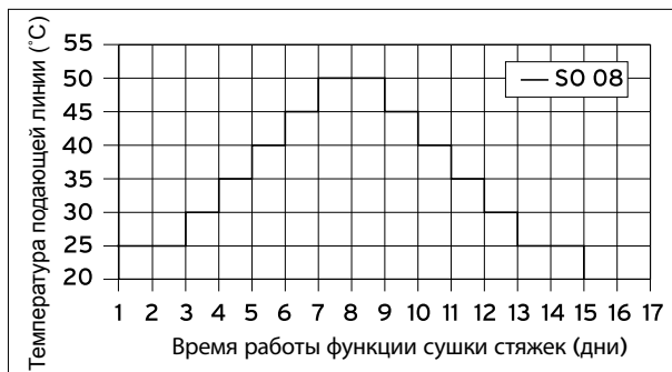
Рис. 6.1 Время выполнения автоматической программы сушки цементных стяжек (параметр SO08 = 50 °C)
